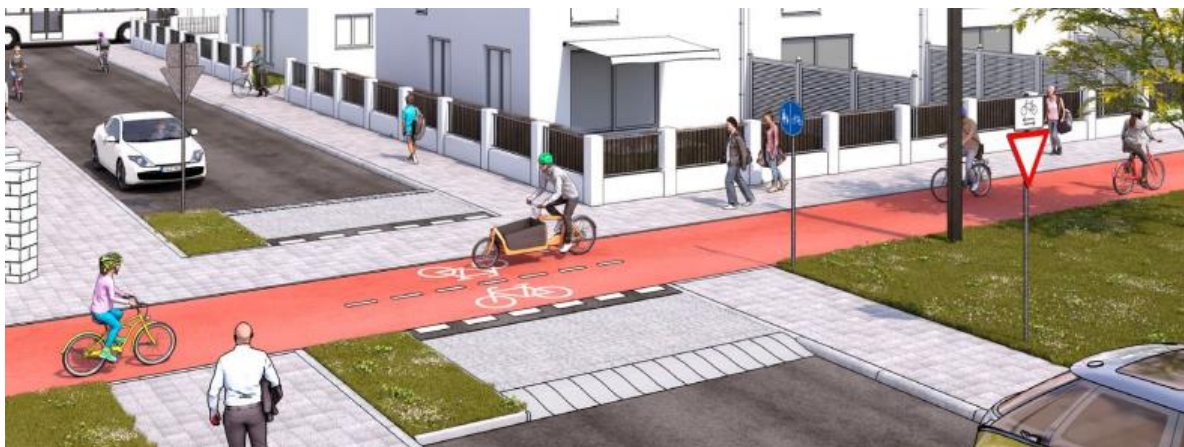
Abbildung 98: Konzeptdarstellung einer exemplarischen Maßnahme mit bevorzugter Straßenüberführung für den Radverkehr (vgl. BMDV, 2022, S. 7)
