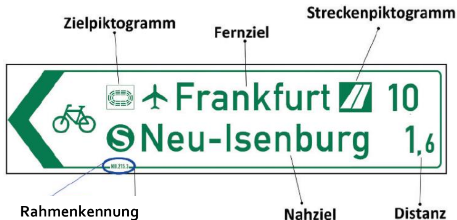
Abbildung 99: Erläuterung der Schilderhalte am Beispiel eines Zielwegweisers (Typ Pfeilwegweiser) (vgl. HMWEVL, 2018)
