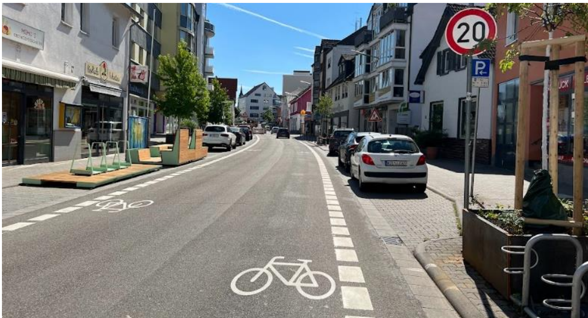
Abbildung 94: Innerstädtische fahrbahnseitige Führung des Radverkehrs durch Fahrradpiktogramme inkl. Dooring-Zone (eigenes Foto (VAR+, 2022))
